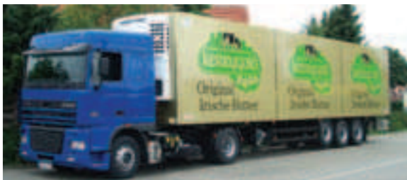
Met op MS polymeer gebaseerde lijm in elkaar gelijmdde trailer.
