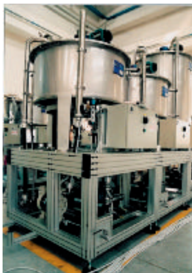
CPS Color: het Auricolor systeem omvat kleurstoffen, doseerapparatuur, kwaliteitscontrole en technische ondersteuning.
