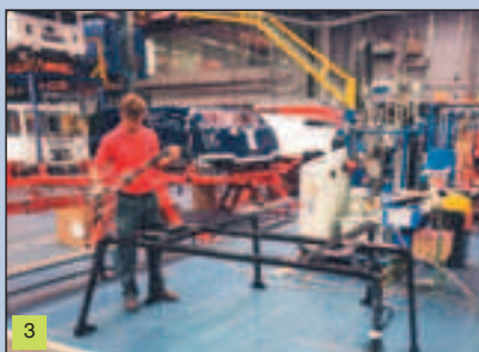
Figuur 3. Lijm aanbrengen op frame Super Space Cab.
