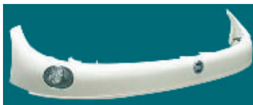
Koplampbehuizing van de Fiat Multipla, verlijmd met Araldite lijm.
