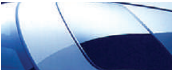
Bij dit schuifdak is het glas op het gelakt metalen frame gelijmd. De lijm moest bestand zijn tegen temperaturen tot 120°C.
