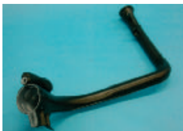
Vulleiding brandstoftank, geblaasvormd op een SIG Kautex KBS2-61.
