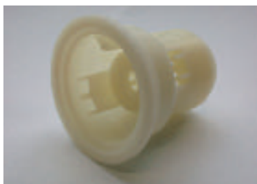
Remonderdeel. Prototype uit RenShape SL 7560 fotopolymeer.
